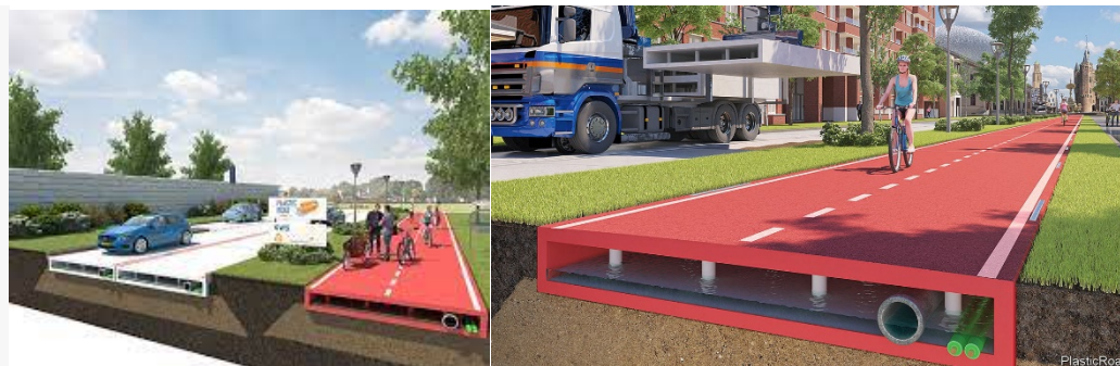
Figure 2. Une structure routière modulaire creuse en plastique recyclé "Plastic Road".
